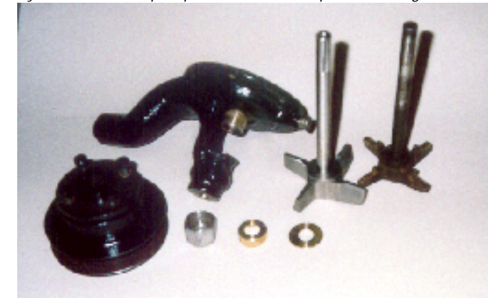
Nyttillverkad vattenpump, den nedslitna impellern till höger.
