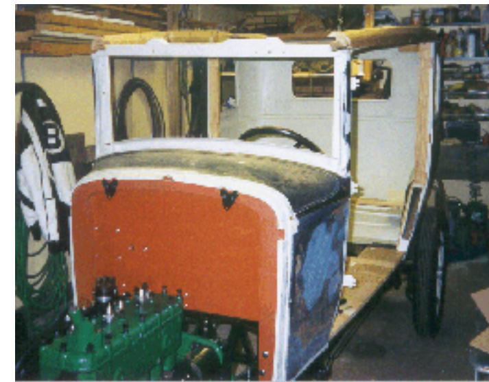
Min 1929 års Nash 420. Provmontering av karossen på chassiet.
