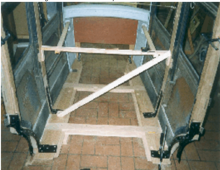
Provmontering av ram och dörrstolpar.
