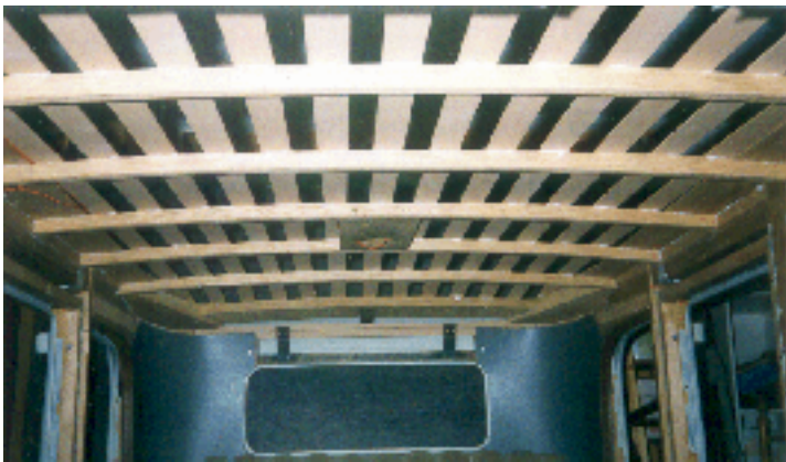
Taket klart. Här syns också lite av karosspappen som sedan ska kläs med plysch.
